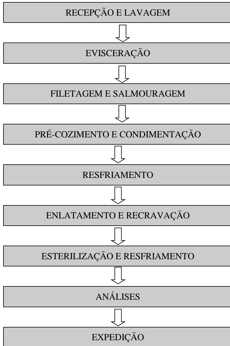
Figura 1. Fluxograma de produção tambaqui ralado ao molho de tomate sabor defumado
