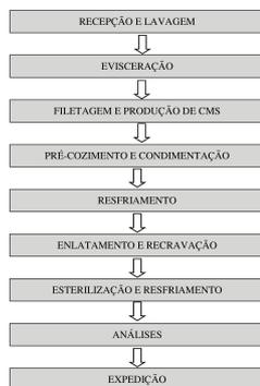
Figura 1. Fluxograma de produção de pintado ralado ao molho de tomate com pimentão
