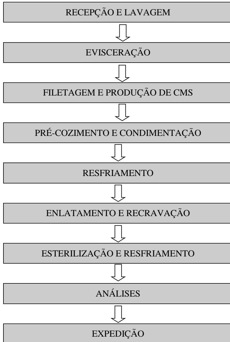
**Figura 1.** Fluxograma de produção pintado ralado ao molho de tomate com pimentão
