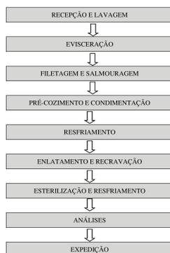
Figura 1. Fluxograma de produção de pirarucu ao molho de tomate com pimentão sabor defumado
