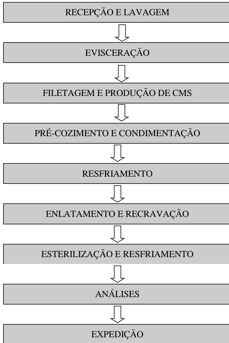
Figura 1. Fluxograma de produção de patês cremoso e pastoso, enlatados e esterilizados a base de peixes de água doce, sabor defumado ou não
